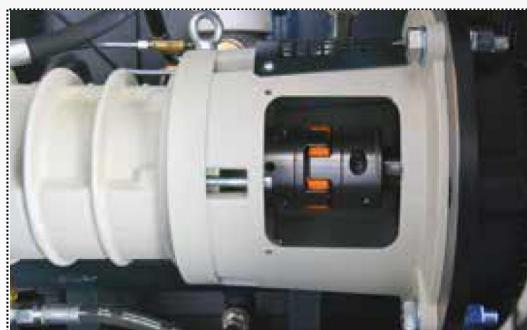
Kompresory řady **BLADE 8 - 12** byly navrženy tak, aby umožnily výměnu pružné spojky mezi elektromotorem a kompresorem bez nutnosti rozebrat jednotku stator-rotor.
